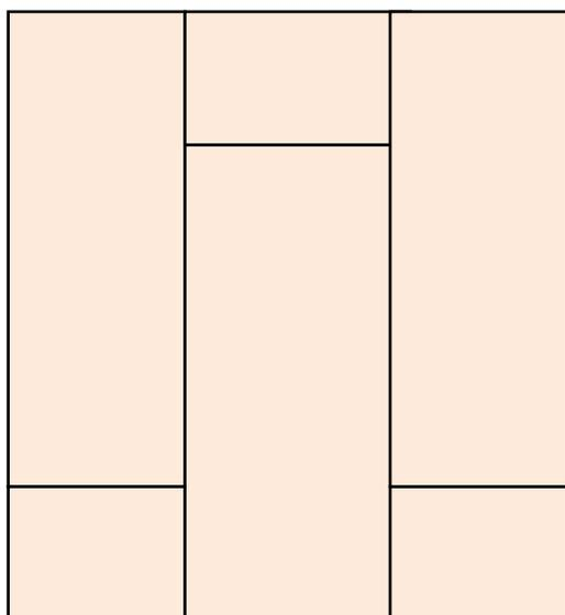
天井高2,400mmの際は8尺ボードを使用し吹抜けや継ぎ足し張りの際は、千鳥張りをすることで、クラックを最大限に防止します
